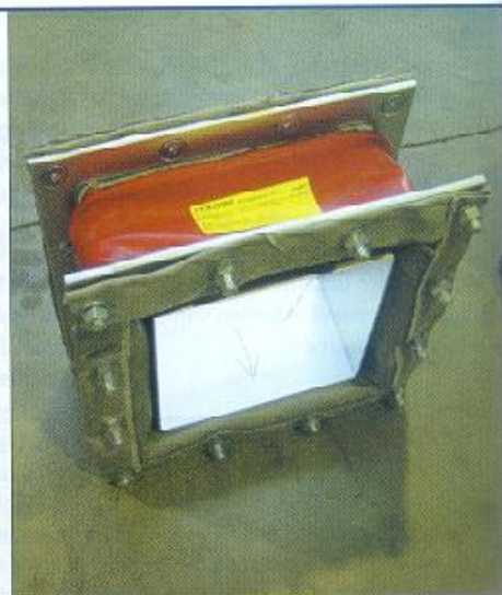
Weichstoff-Kompensator in einer Müllverbrennungs-Anlage
