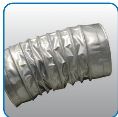
**Faltenbalg für Lufttechnische Anlagen, aus beidseitig Silikonbeschichtetem Glasgewebe. Medium: Luft, 120° C, Druck +50 mbar, Strömungsgeschwindigkeit 28 m/s.**
