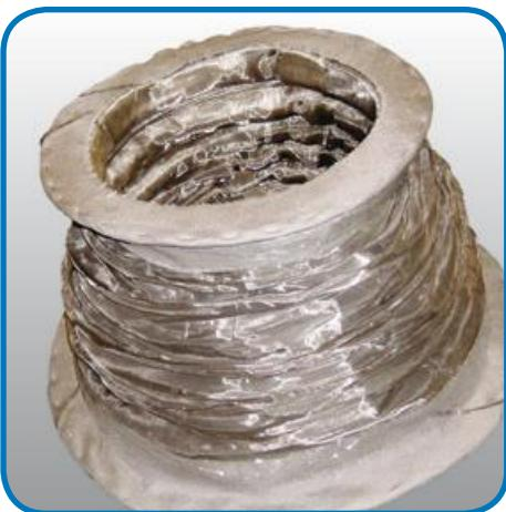
Extrem hitzebeständiger Faltenbalg an der Walzenverstellung eines Walzwerkes. Medium: N2/H2-Gemisch, bis 700 ° C. Stauchung 110 mm, Versatz bis 130 mm.
